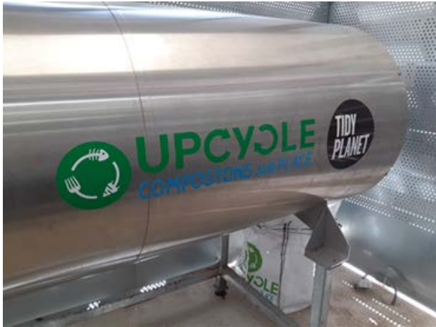
Photo : composteur électromécanique (capacité 500 kg)
